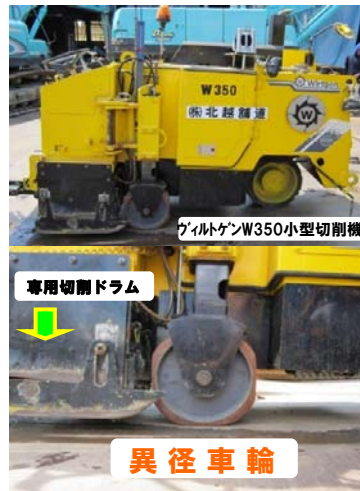
切削施工状況 この後スィーパーで廃材を集めます
