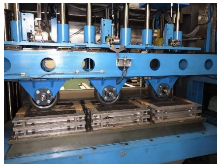
ホイールトラッキング試験状況
