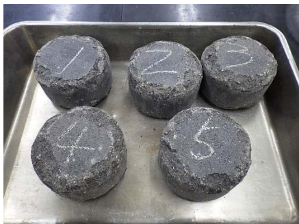
カンタブロ試験後の供試体
